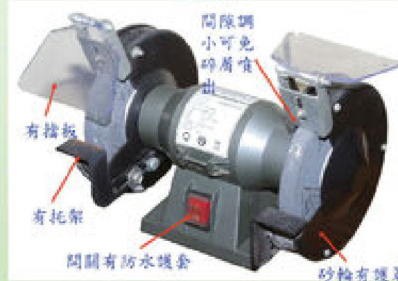
砂輪研磨機的安全防護圖例
